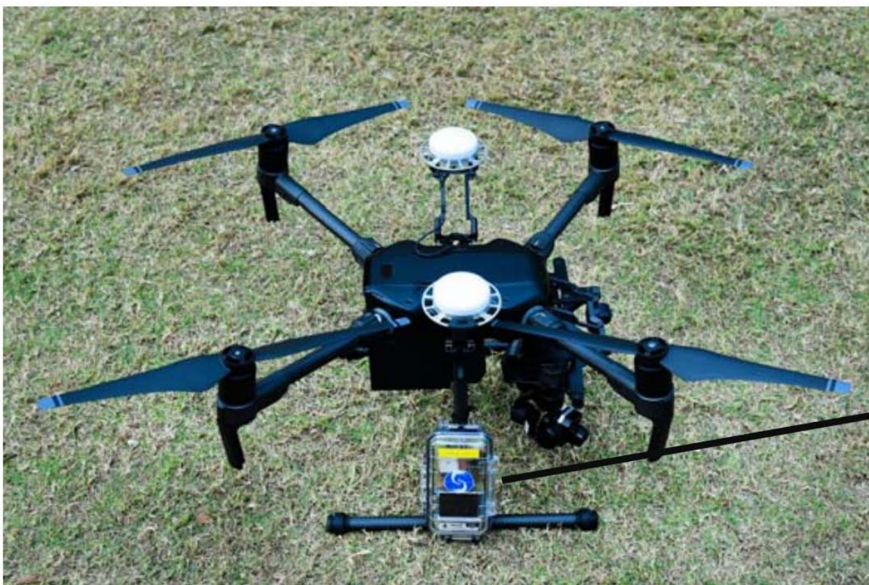
安裝在無人機上的微氣候 監測儀器 Microclimate sensors installed on a drone
